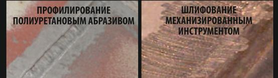
«нарушения покрытий обычно возникают в углах и на угловых элементах, вначале на очищенных механическим инструментом поверхностях монтажных площадок»
