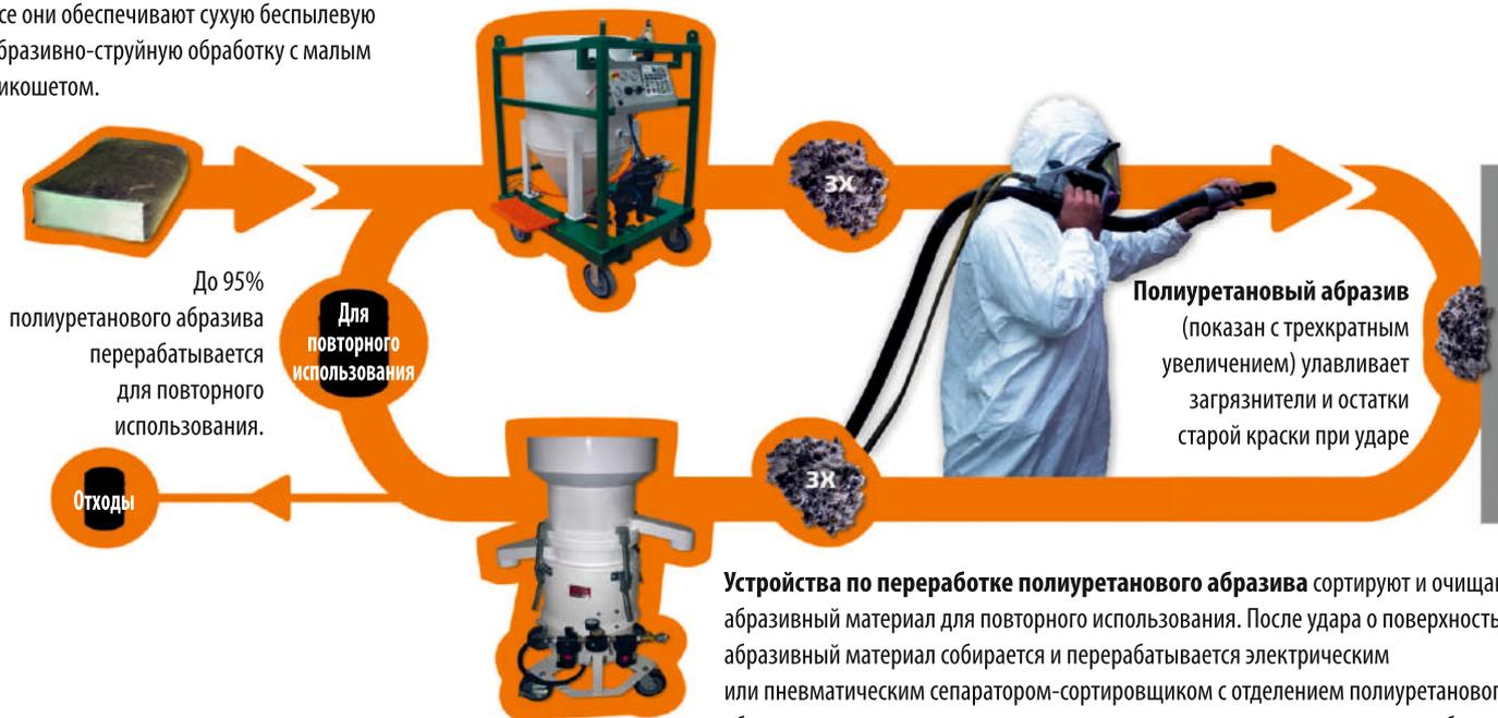
Устройства по переработке полиуретанового абразива сортируют и очищают абразивный материал для повторного использования. После удара о поверхность абразивный материал собирается и перерабатывается электрическим или пневматическим сепаратором-сортировщиком с отделением полиуретанового абразива, пригодного для повторного использования, от частиц чрезмерно большого размера и мелких фракций отходов (отработанный абразив и загрязнители).
